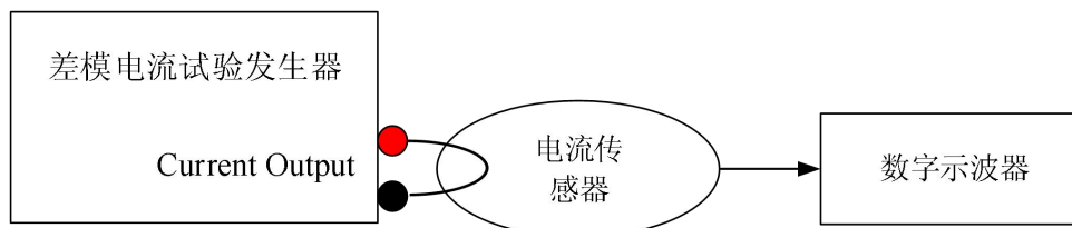
图 6 差模电流试验发生器短路电流和频率校准示意图
