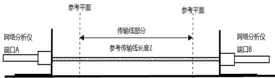
图 G.4 “传输线”的校准配置
