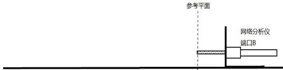
图 G.2 “反射端口 B” 的校准配置
